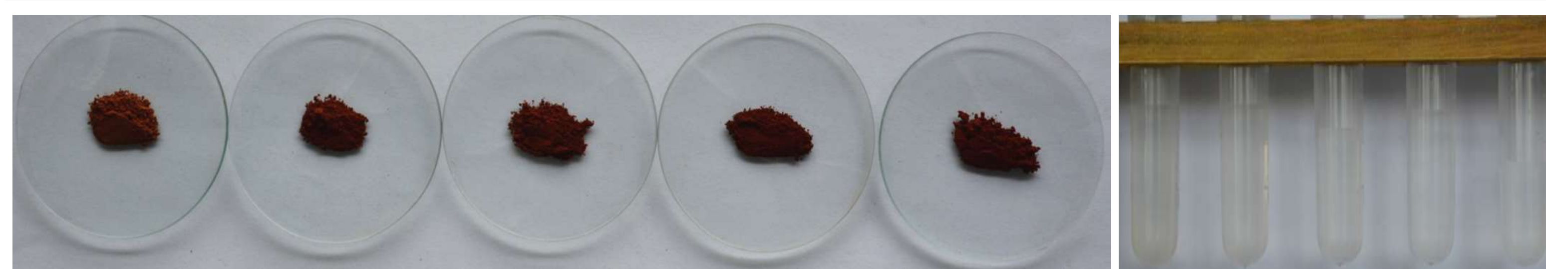
经1M盐酸处理后颜料和上清液的数码照片
